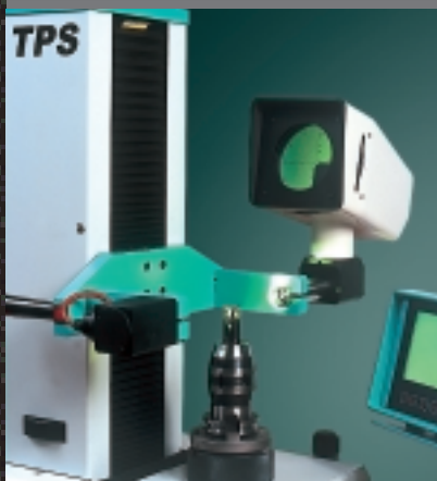
Regolazione fine degli assi X e Z tramite due rotelle a mano.
