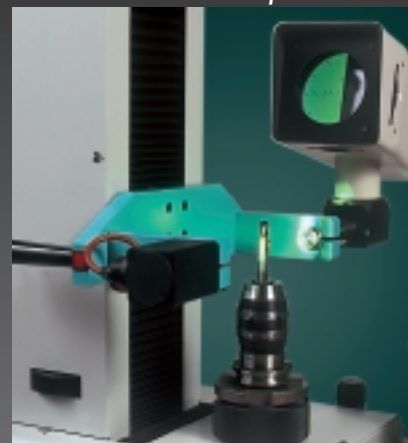
Impugnatura ad una mano per il pratico spostamento degli assi con pulsante rosso di blocco-sblocco pneumatico
